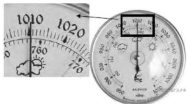
нижняя шкала — в мм рт. ст. Погрешность измерений давления равна цене деления шкалы барометра. Запишите в ответ величину атмосферного давления, выраженного в мм рт. ст., с уч том погрешности измерений. В ответе запишите значение и погрешность слитно без пробела.
